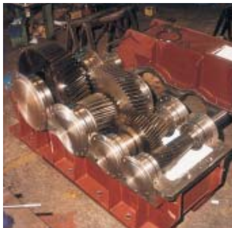
Reductor Z3-450E para elevación de grúa. Z3-450E gear box for lifting crane.
