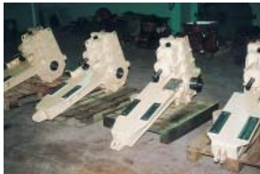
Reductores XPTTVH-200 E, con soporte para freno y motor.
