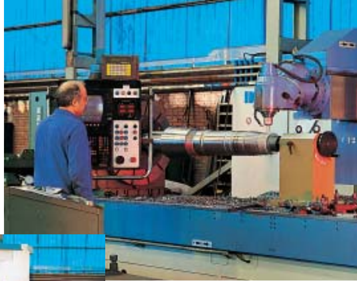
Fresadora "Correa" CNC, modelo CF-40/40, 4.000 mm x 1.500 mm x 1.200 mm, en proceso de mecanización de un eje.
