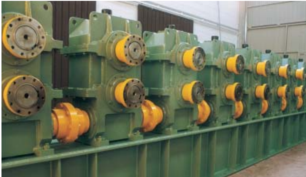
Reductores RL-70, para laminador de perfiles. RL-70 gear box for section-mill.
