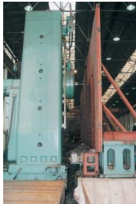
Mandrinadora M-160 de columna móvil, mesa giratoria de 3.500 x 2.500 mm, con un recorrido de 7.755 x 2.900 mm y visualizador digital.
