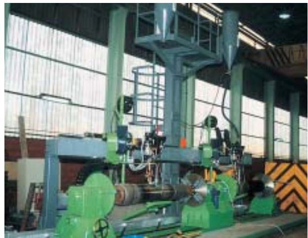
Fabricación de una máquina de recargue de rodillos de colada continua.
