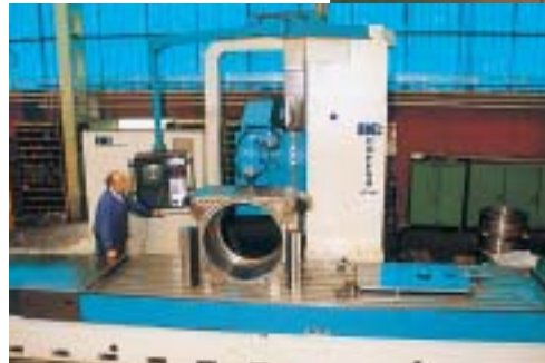
Fresadora "Correa" CNC, modelo CF-40/40, 4.000 mm x 1.500 mm x 1.200 mm, en proceso de mecanización de un eje.
