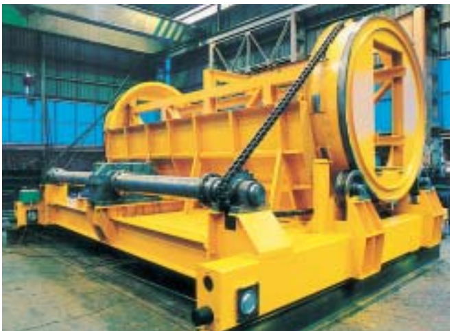
Dispositivo para traslación y volteo de vagones, viradores y posicionadores.
