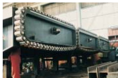
Cadena de rodillos para compuerta de central hidroeléctrica.
