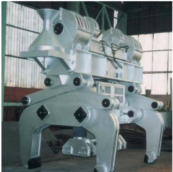
Pinza para slabs de 75 t. Tong for 75 t slabs.
